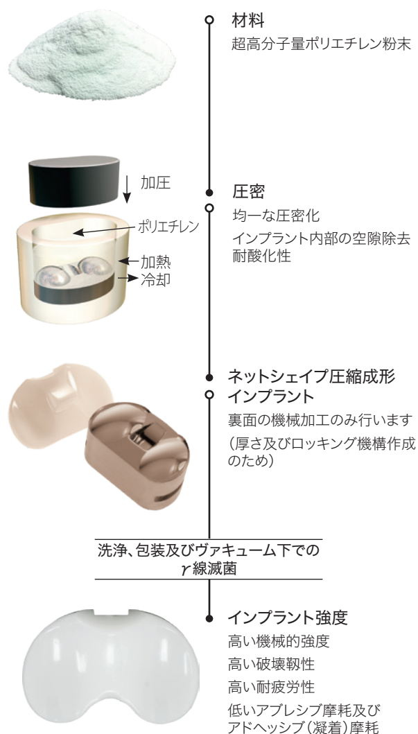
図2. NCMポリエチレンインサートの製造工程
